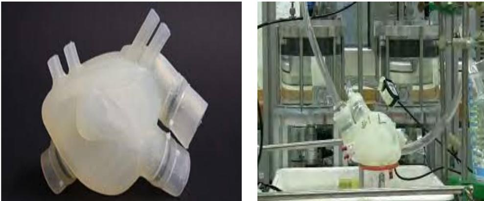
Fig. 15. Corazón de silicona realizado con impresión 3D
